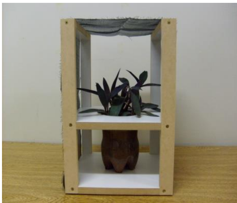
Figura. 5. Sistema para exposição de Tradescantia em biomonitoramento in situ .
