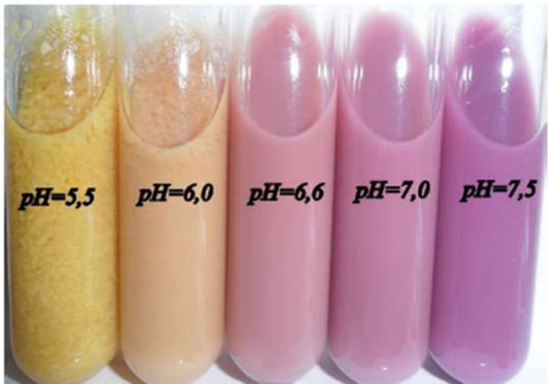
Figura 1. Tubos de ensaio com amostras de leite após o teste do alizarol. Amostras com pH 5,5 e 6,0: leite ácido; amostra com pH 6,6: leite normal; amostra com pH 7,0 e 7,5: leite alcalino
