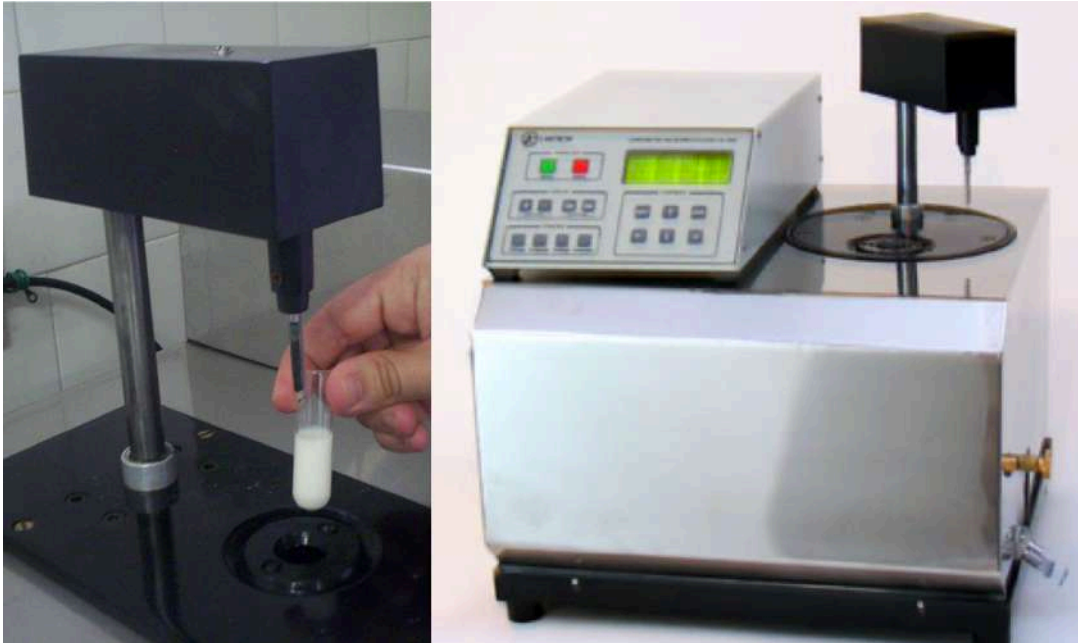
Figura 3. Análise de crioscopia e equipamento de crioscopia.
